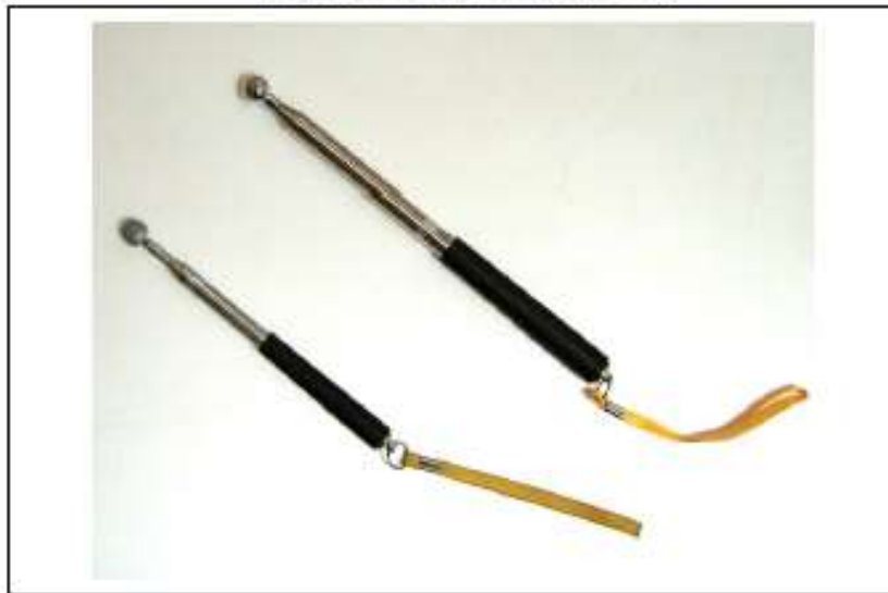
打診法調査に使用する器具の外観
